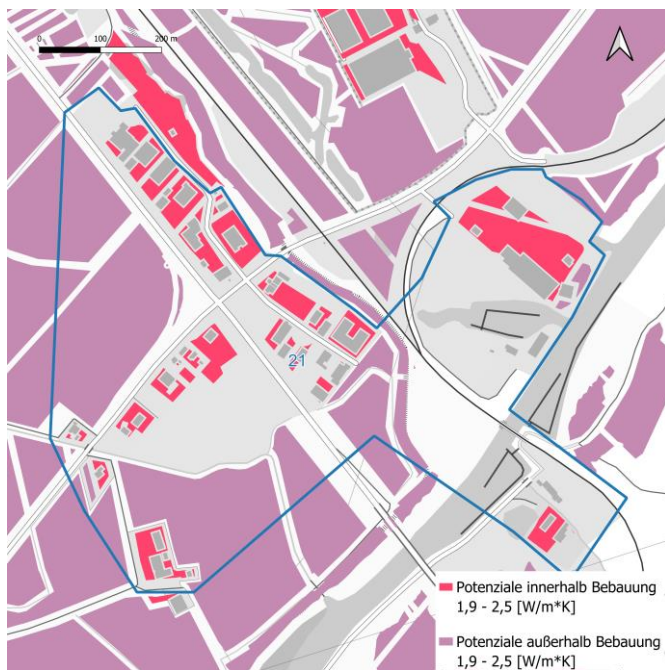
Nutzung von oberflächennaher Geothermie durch Erdwärmesonden
