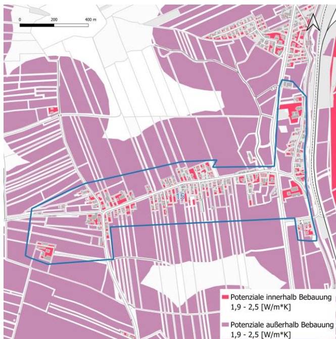
Nutzung von oberflächennaher Geothermie durch Erdwärmesonden
