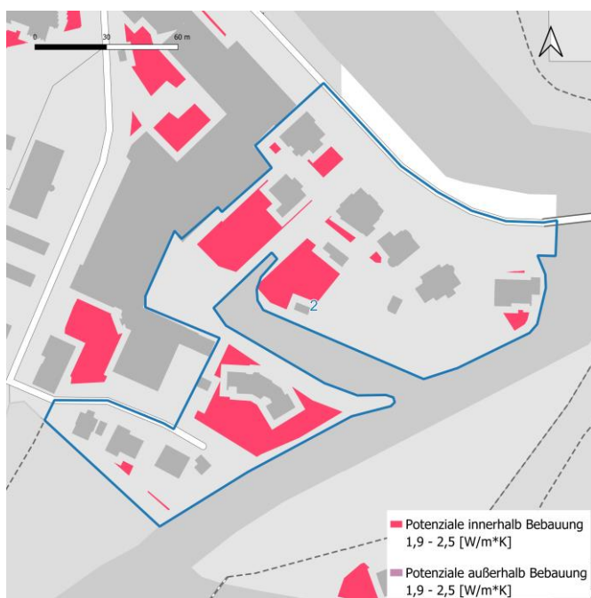
Nutzung von oberflächennaher Geothermie durch Erdwärmesonden
