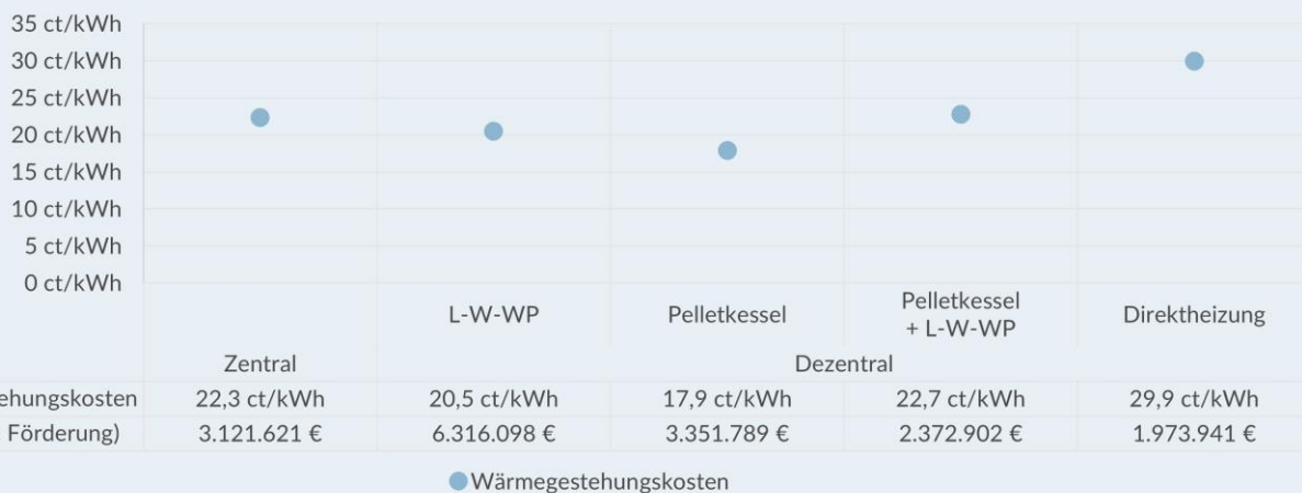
Durchschnittliche Wärmekosten über 20 Jahre (100 MWh/Haushalt/a)
