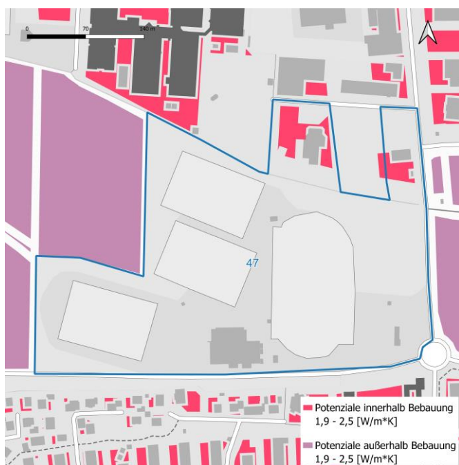
Nutzung von oberflächennaher Geothermie durch Erdwärmesonden
