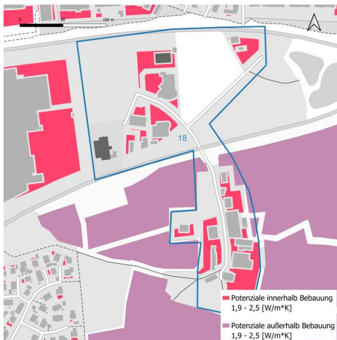
Nutzung von oberflächennaher Geothermie durch Erdwärmesonden
