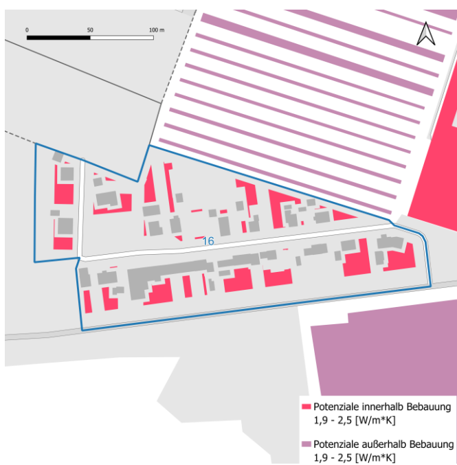
Nutzung von oberflächennaher Geothermie durch Erdwärmesonden
