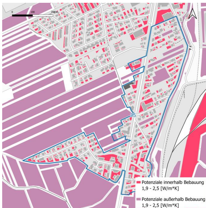
Nutzung von oberflächennaher Geothermie durch Erdwärmesonden
