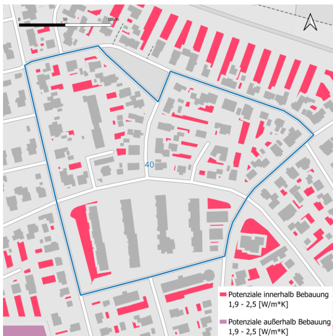
Nutzung von oberflächennaher Geothermie durch Erdwärmesonden
