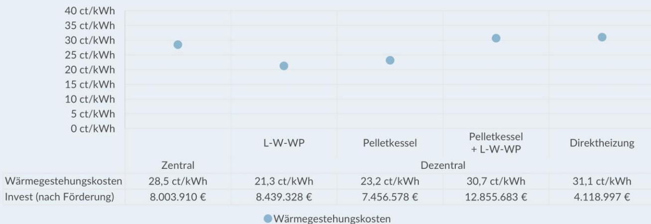
Durchschnittliche Wärmekosten über 20 Jahre (21 MWh/Haushalt/a)
