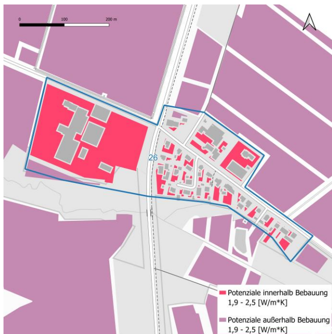
Nutzung von oberflächennaher Geothermie durch Erdwärmesonden
