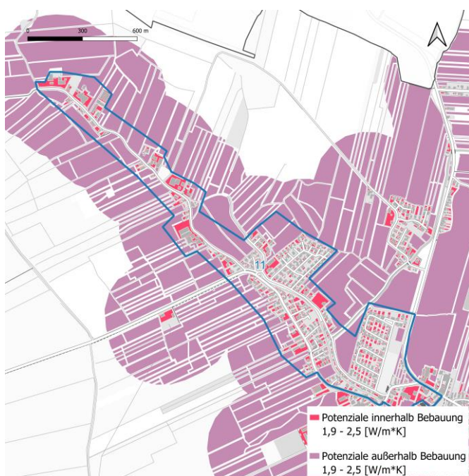
Nutzung von oberflächennaher Geothermie durch Erdwärmesonden
